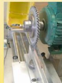
Découpe de planchette / scie double lame
