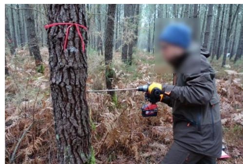
Prélèvement à la tarière électrique
